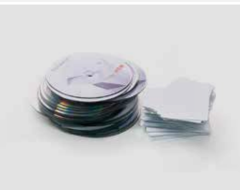
Dysk twardy zniszczony w HSM StoreEx HDS 150 w stopniu bezpieczeństwa H-3.
